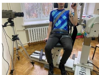
Rys. 1. Pomiary z wykorzystaniem elektromiografii EMG i dynamometru izokinetycznego Biodex – badania własne
