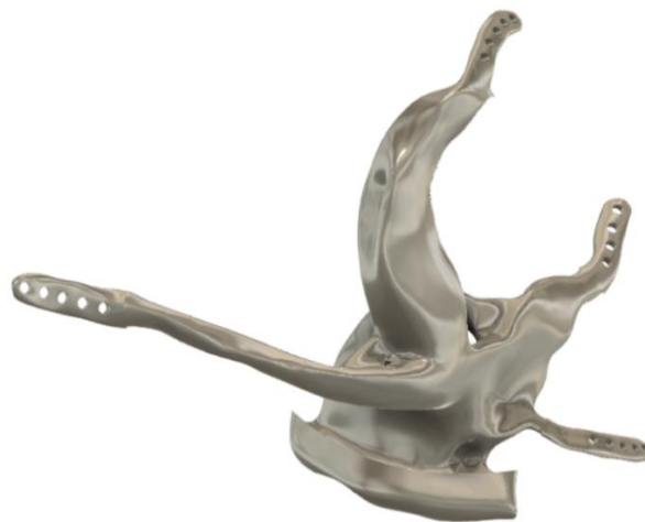
Rys. 7. Geometria implantu kości jarzmowej uzyskana z wykorzystaniem projektowania generatywnego dla obciążenia 400 N
