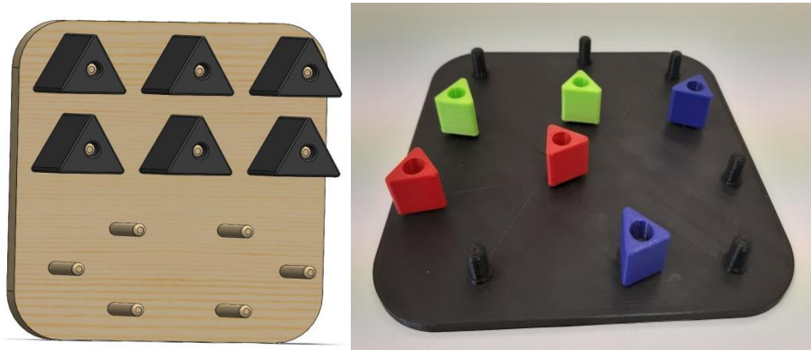
Rys.2. Zestaw ćwiczeniowy do chwytania prostych kształtów: wizualizacja wykonana w programie SolidWorks2020 (z lewej), model fizyczny (z prawej)
