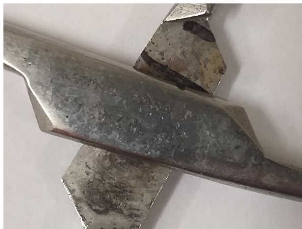
Rys.3 Obraz makroskopowy złącza imadła przedstawiający korozję powierzchniową, osad i liczne pory znajdujące się na powierzchni narzędzia
