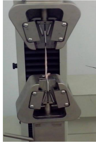
Rys. 1. a) Maszyna wytrzymałościowa MTS Insight 2, b) preparat zamocowany w uchwytach
