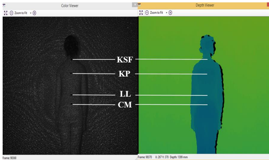
Rys.2. Środowisko umożliwiające określenie punktów w przestrzeni trójwymiarowej z naniesionymi punktami: KSF, KP, LL oraz CM
