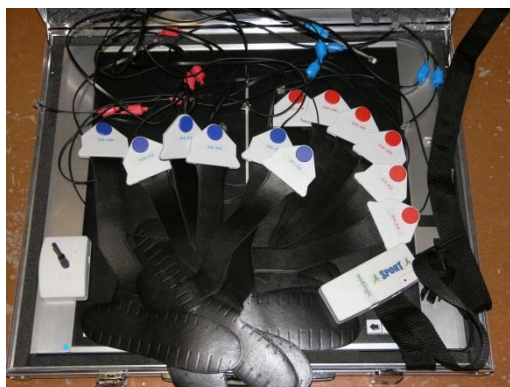
Rys.1. Baropodometryczny system do badania stóp
