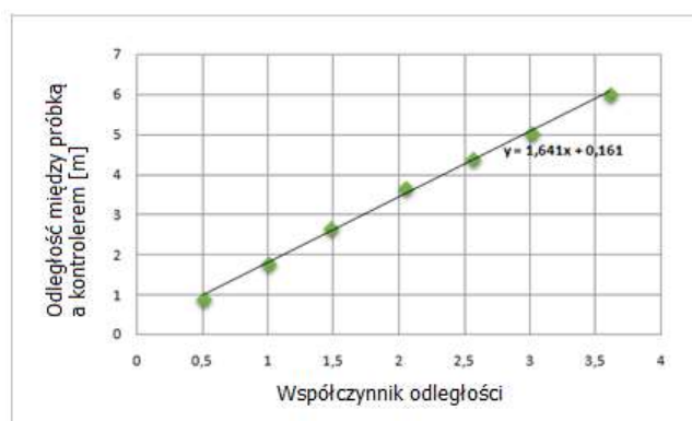
Rys. 2. Zależność współczynnika odległości od odległości między próbką a kontrolerem
