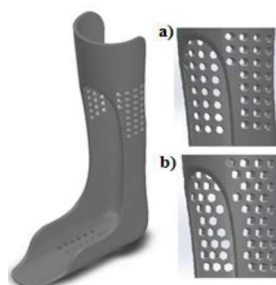
Rys. 2. Model ortezy GRAFO z wykonanymi otworami o kształcie: a) koła, b) sześciokąta
