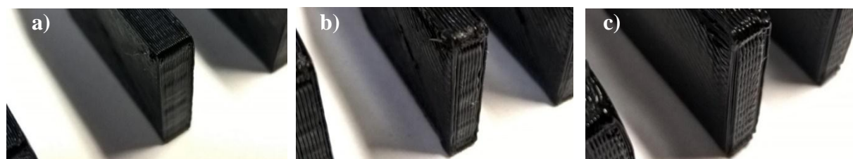
Rys. 5. Porównanie jakości wykonania powierzchni bocznych w zależności od przyjętych parametrów druku: a) szybkość druku 10 mm/s, b) wysokość warstwy 0,4 mm, c) wypełnienie 80%
