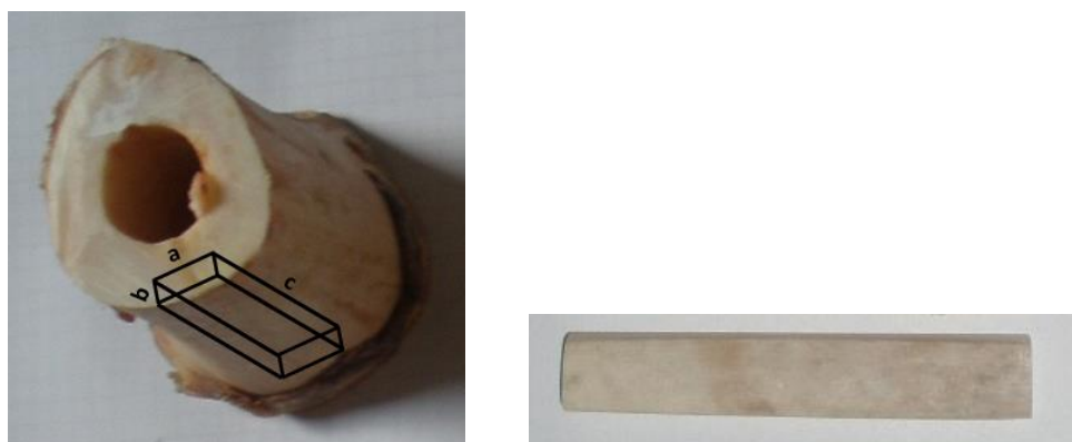
Rys. 2. Przykład próbki: schemat (z lewej), po wycięciu (z prawej)
