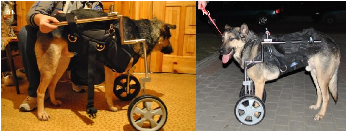
Rys. 7. Przekazanie zaprojektowanej konstrukcji dla potrzebującego zwierzęcia: a) dopasowanie wózka do psa; b) pies w trakcie spaceru w skonstruowanym wózku inwalidzkim
