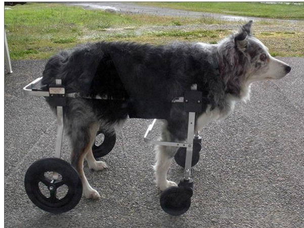
Rys. 2. Przykładowe rozwiązanie konstrukcyjne wózka inwalidzkiego dla psa [8]
