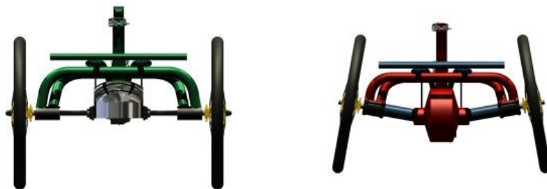
Rys.4. Położenie kół względem podłoża: a) pionowe, b) skośne
