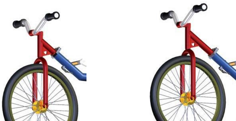
Rys.5. Mechanizm umożliwiający regulację długości ramy
