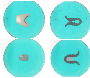
Rys. 2. Zgłady metalograficzne, od góry z lewej: wycinek poprzeczny siodła protezy wraz z częściami akrylowymi, element łuku protezy, od dołu z lewej: element laboratoryjny imitujący siodło protezy, element laboratoryjny imitujący łuk protezy
