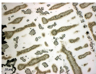
Rys. 10. Szczegół rysunku 6, mikrostruktura dendrytyczna, skupiska eutektyk na granicach ziarn, trawiono, pow. 1000x
