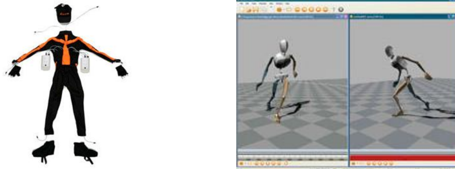
Rys. 16. A) Kombinezon Moven z wbudowanymi czujnikami inercyjnymi, B) okno programu Moven Studio
