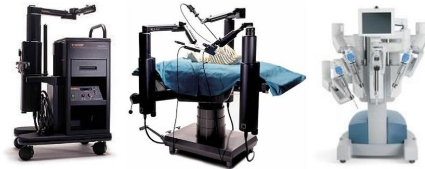
Rys.2. Systemy chirurgiczne Aesop, Zeus, Da Vinci [9,10,11]
