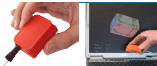
Rys. 14. Czujnik inercyjny MTx firmy Xsens oraz wizualizacja on-line odzwierciedlająca jego ruchy [13]
