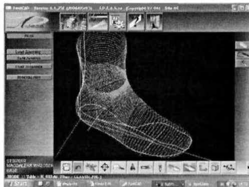
Rys. 6. Siatka stopy w programie FootCAD
