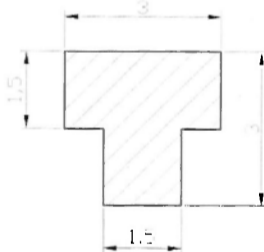
Rys.4. Przekrój teowy wykorzystany do budowy przęsła mostu
