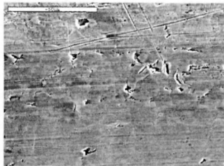
Rys. 5. Żelazo miedziowane – pow. 1000x
